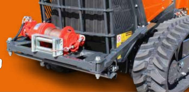
Verricello idraulico utile per il traino della macchina stessa in caso di necessità. Possiede una capacità di traino di 1400 kg, che aggiunta alla potenza della macchina ne aumenta la forza per assicurare la massima affidabilità.
